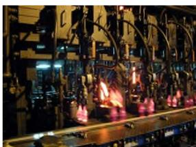
Le verre fondu s'écoule ensuite dans un petit bassin de fusion (feeder). Des gouttes de verre mesurées de manière précise sont coupées automatiquement et tombent dans un moule ébaucheur de l'automate de fabrication du verre.
