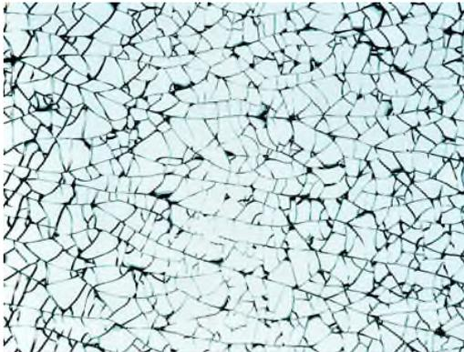
Le verre de sécurité trempé (VST) éclate en nombreux petits morceaux lorsqu'il casse. Il est utilisé sur les vitres arrière et latérales des voitures.
