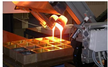
Voici comment cela fonctionne: un bras robotisé prend un creuset vide et le place sur une balance roulante. Ensuite, jusqu'à dix matières premières sont adaptées individuellement au mélange et pesées dans le creuset afin que 100 g de verre environ puisse être fondu, une quantité suffisante pour obtenir les propriétés du verre.
