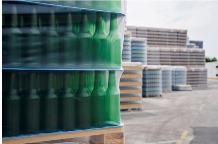
Die Glaswaren werden vollautomatisch auf Paletten gereiht und mit einer Folie überzogen. Verpackt kommen sie anschliessend in das Fertigwarenlager oder direkt zur Auslieferung.
