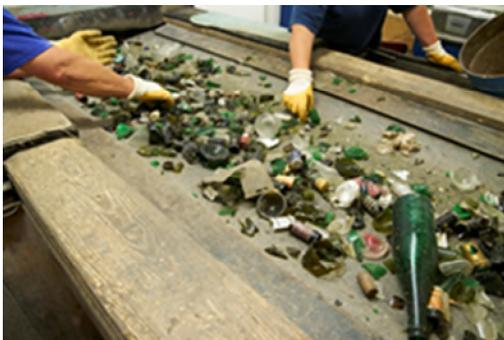
**Das Einschmelzen von Altglas braucht weniger Energie, als das Einschmelzen von Primärrohstoffen.** Je höher der Anteil an Altglas, desto höher der Energiespareffekt. Entscheidend ist die Aufbereitung des Sammelguts, denn für die Herstellung von Weissglas können nur Scherben aus Weissglas verwendet werden. Der Anteil des Altglases variiert deshalb je nach Glasfarbe.
