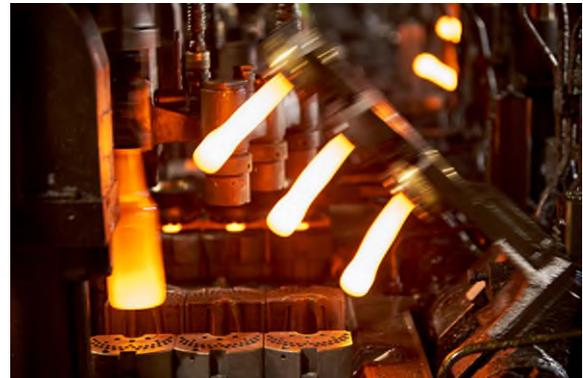
Der Ofen heizt die Mischung auf 1580 Grad Celsius auf. Das Altglas und die Primärrohstoffe schmelzen. Das flüssige Glas fließt ständig nach, es werden glühende Glaspfropfen abgeschnitten und zu den gewünschten Formen geleitet.
