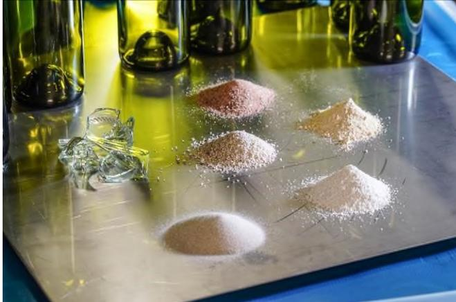
**Aus Quarzsand, Soda, Kalk, Dolomit und Feldspat kann man Glas herstellen.**
