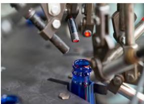
Nach Verlassen des Kühllofens werden alle Behälter optisch, mechanisch und elektronisch auf Fehler geprüft. Was nicht den Anforderungen entspricht, wird schonungslos ausgeschieden und in den Schmelzofen zurückgeführt. Nach der Qualitätskontrolle wird das Glasprodukt verpackt und ausgeliefert.
