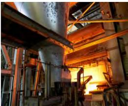
Bei rund 1580 Grad Celsius werden das Altglas und die neuen Rohstoffe in einer Schmelzwanne geschmolzen, um alles in eine flüssige Glasmasse umzuwandeln.
