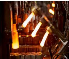
Danach fließt das flüssige Glas in eine kleine Arbeitswanne (Feeder). Hier werden automatisch genau abgemessene Glaspforten geschnitten, die in eine Vorform des Glasherstellungsautomaten fallen.
