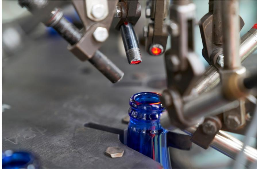
Am Ende der Produktion werden die Glasbehälter optisch, mechanisch und elektronisch auf Fehler geprüft. Produkte, die nicht Ordnung sind, werden wieder eingeschmolzen.
