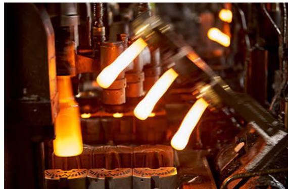
Der Ofen heizt die Mischung auf 1580 Grad Celsius auf. Das Altglas und die Primärrohstoffe schmelzen. Das flüssige Glas fließt ständig nach, es werden glühende Glaspfropfen abgeschnitten und zu den gewünschten Formen geleitet.
