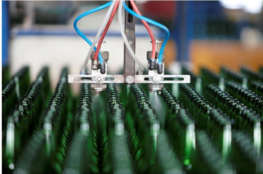
Im Kühllofen werden die noch rot glühenden Gläser und Flaschen ganz allmählich abgekühlt, um Materialspannungen zu lösen (bei schnellem Abkühlen zerspringt das Glas). Die Oberfläche wird anschliessend so behandelt, dass sie vor Kratzern geschützt ist.
